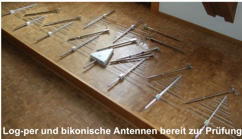
Log-per und bikonische Antennen bereit zur Prüfung
